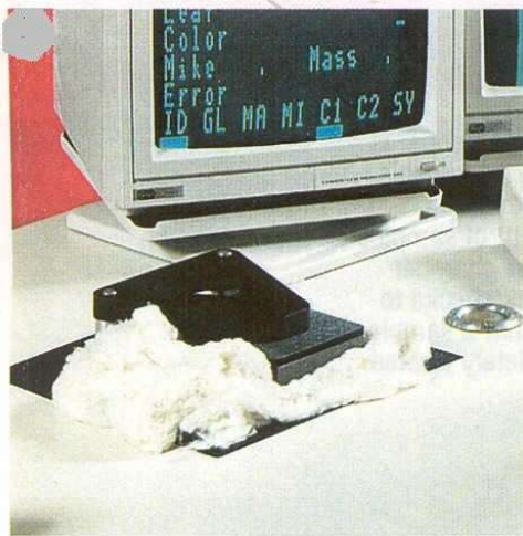
Resim 5. Renk ve Yabancı Madde Tayininde Işık Geçmeyecek şekilde Numunenin Kapatılması
